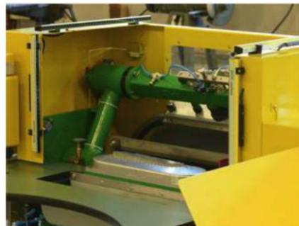
SICK-lichtschermen in bobineermachine
