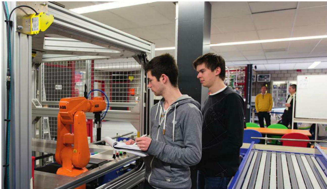
De veiligheidscamera (linksboven) zorgt voor de ingrijpbeveiliging
