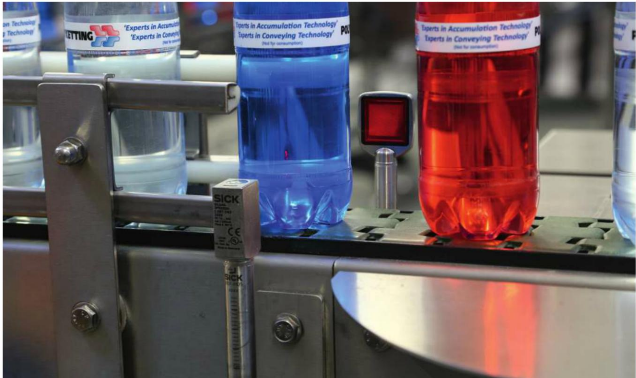
De W4 bewaakt de toevoer en de uitgang van de buffertafel.
