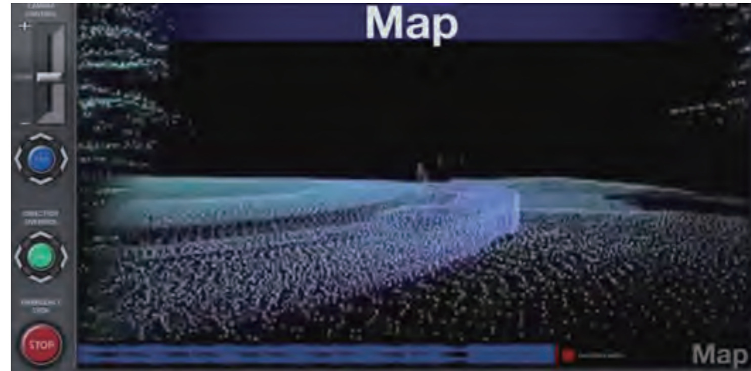
安防机器人通过激光扫描器产生的周边轮廓数据构建实时地图
