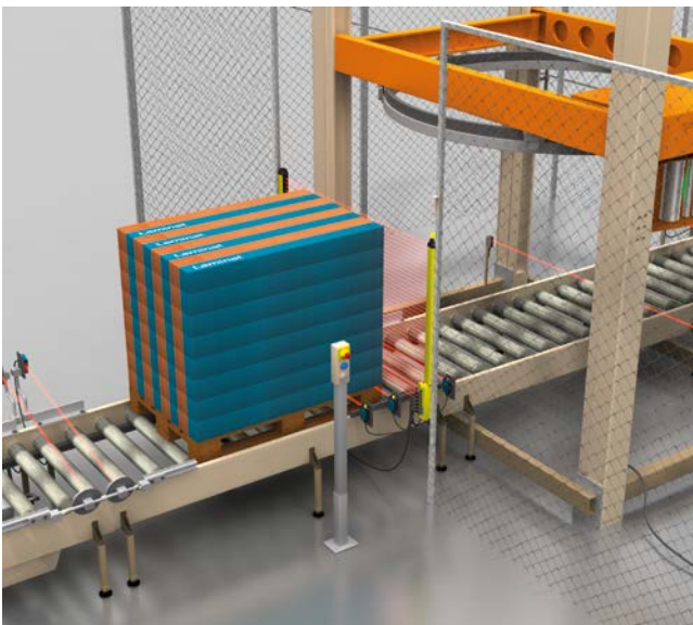
Bild 20: Muting-Funktion mit Sicherheits-Lichtvorhang und Muting-Sensoren an einer Folienwickelmaschine.
