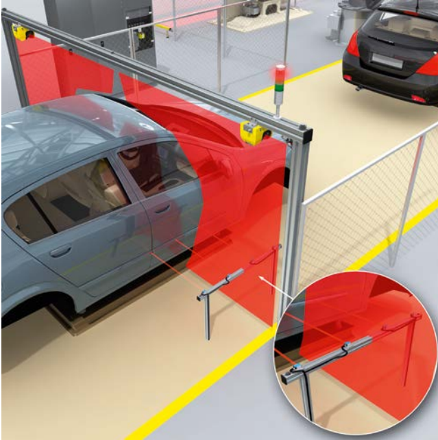
Bild 23: Materialdurchfahrt mit Sicherheits-Laserscannern, senkrechten Schutzfeldern und Schutzfeldumschaltung durch geeignet angeordnete Sensoren.
