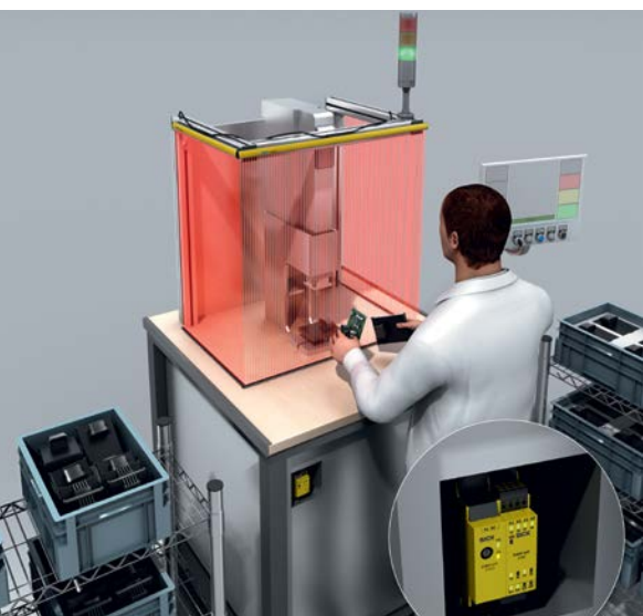
PSDI 模式控制:手动装料压力机上的压合周期。
