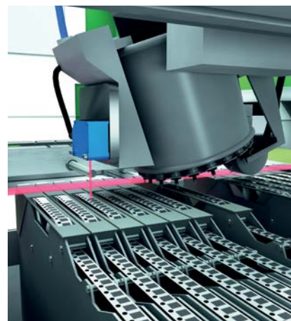
OD Mini: 机器人辅助产品自动化中的距离测量。
