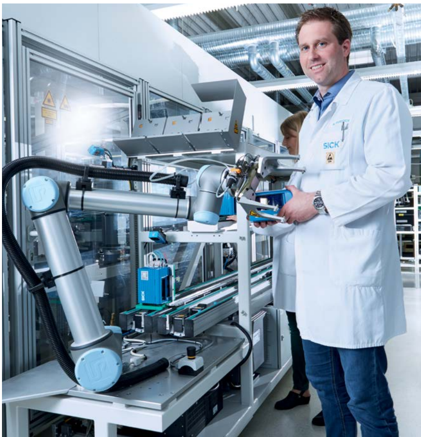
凭借可安装在机器人上的 2D 摄像机 Inspector PIM60,机器人可识别事先已定义物体的位置。
