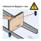
Sobald der Mindestfüllstand unterschritten wird, detektieren die Sensoren, dass Material fehlt. Die Sicherheitsfunktion des befüllten Magazins ist nicht mehr gewährleistet. Es kommt zur sicherheitsgerichteten Abschaltung der Anlage.
