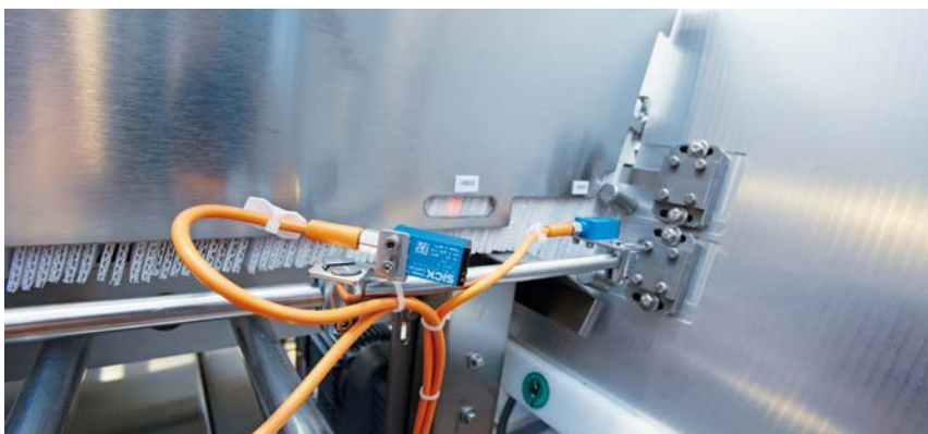
尺寸小巧的漫反射光电传感器 MultiPulse 几乎不需要什么空间。
