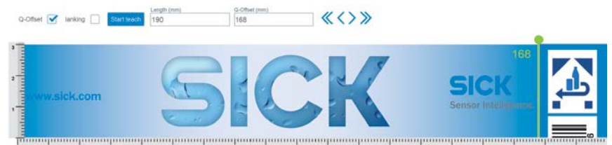
直接在图像上定义开关点(绿线)。
