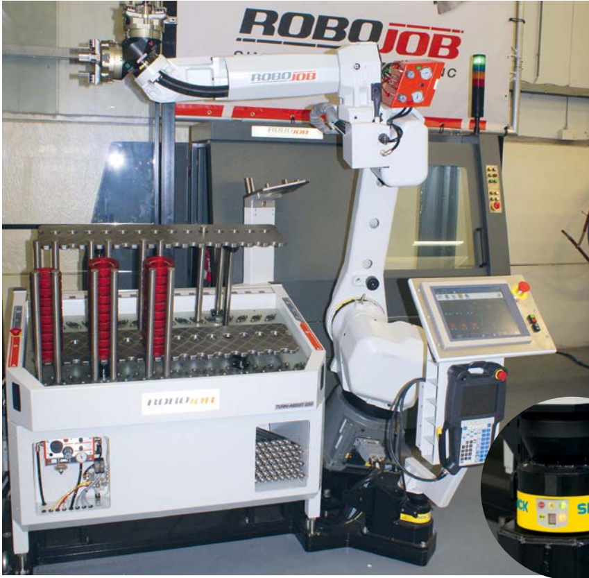
使用 RoboJob 的机器人解决方案给机床自动上料。
