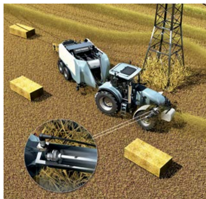
全自动车道引导:实现自主拖拉机的重要一步。
