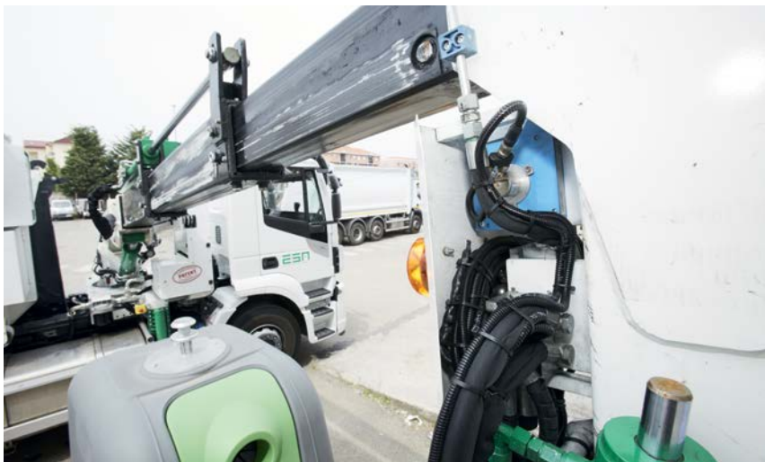
狭长的拉线编码器 EcoLine 可靠检测抓臂的伸出距离。
