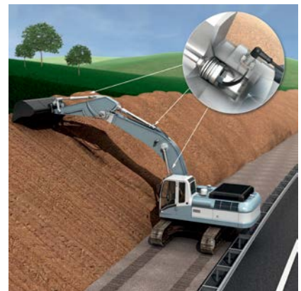
找平高速公路土堤:全自动并以度数级精度。
