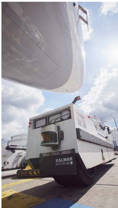
驾驶辅助系统 APS 协助飞机牵引车驾驶员移动飞机。
