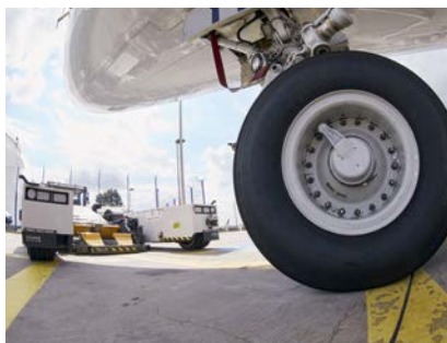
LMS511 测量飞机轮子以确定飞机型号。
