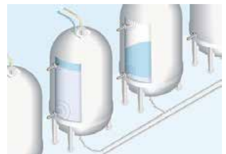
TDR is geschikt voor verschillende vloeistoffen zelfs in vacuüm
