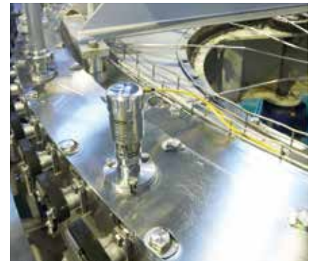
LFP Inox: uitermate geschikt voor niveaumeting van vloeistoffen met schuimlaag
