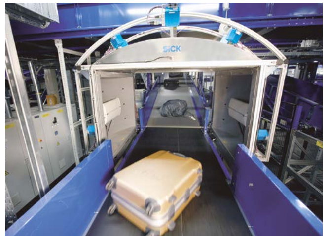
SICK ALIS系統可靠識別與採集航空行李資訊。
