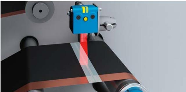
Detección de uniones de empalme en láminas.
