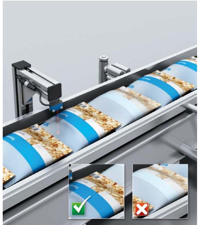
Detección de embalajes con impresión defectuosa.
