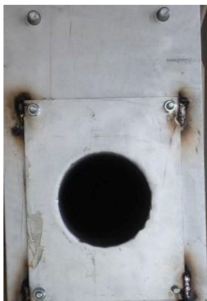
Abb. 22: Schutzrohrflanschplatte mit Montageplatte verschweißt
