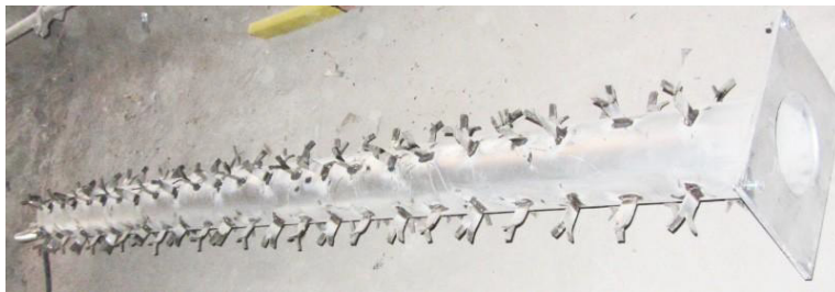
Abb. 21: Schutzrohr mit angeschweißten Verankerungsmetalteilen
