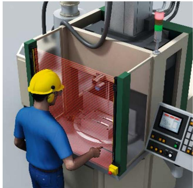
**ReLy: Gefahrstellenabsicherung an einer Presse**
