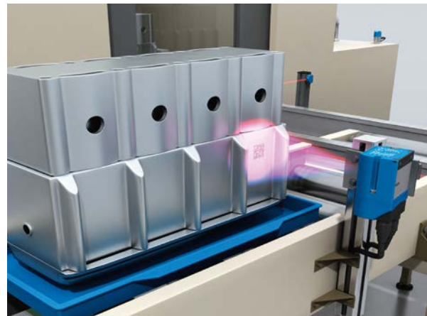
図8: マトリクスカメラは、例えば小さな梱包物のソートプロセス中(左)、または製造中のエンジンブロックなどのコンポーネントを明確に識別するために(右)、印刷あるいは直接マーキングされた1Dコードおよび2Dコードを読み取ります。
