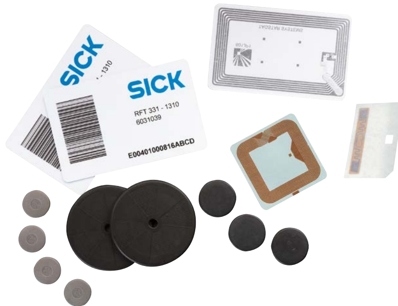
図2: HFおよびUHF RFIDのパッシブトランスポンダには様々な形状があり、対象物への取り付けおよび識別カードとして簡単に使用できます。UHFタグおよびHFタグのアンテナとチップのデザインは、エネルギーとデータの伝送方法によって明確に異なります (右端のタグ: UHF、その他: HF)。
