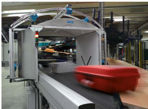
図1: RFIDとレーザーキャナ技術の組み合わせは、例えば空港の手荷物識別システムの手荷物仕分け (左) およびセルフバッグドロップ (右) で使用されます。
