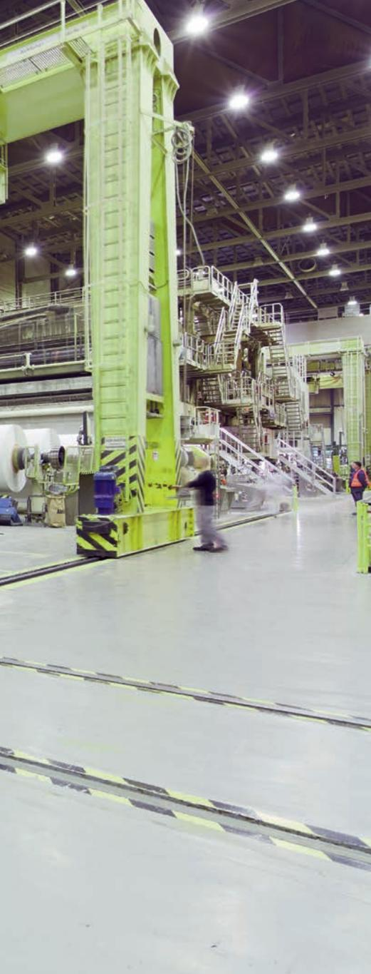
bobinas de papel están suspendidas a lo largo de la nave. Los puentes grúa suspendidos las transportan de una etapa de procesamiento a la siguiente. Dependiendo del grosor concreto del papel, las bobinas de 7,20 metros de ancho contienen entre 50.000 y 60.000 metros de producto, y pesan hasta 20 toneladas.
