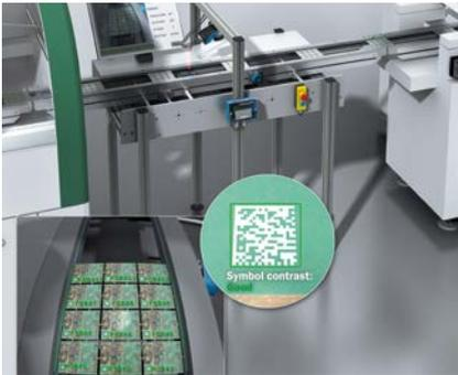
Der kamerabasierte Codeleser Lector63x kann alle Codes auf einem Leiterplattennutzen identifizieren. Das besondere Softwareskript ermöglicht es, einzelne Codes nach Kundenwunsch selektiv auszugeben oder zu serialisieren. Die Leserate lässt sich durch die Aufnahme mehrerer Bilder aus verschiedenen Winkeln erheblich steigern. Durch sein großes Sichtfeld kann der Lector63x sehr flexibel Codes unabhän-
