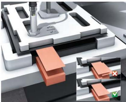
Das Stapeln der Elektroden- und Separatorblätter ist für die Herstellung von Batteriezellen von großer Bedeutung. Werden aufgrund von Adhäsion mehrere identische Blätter gleichzeitig aufgenommen, führt dies zu einer fehlerhaften Zelle. Der induktive Näherungssensor IDF detektiert zuverlässig aneinanderhängende Elektroden und minimiert so den Ausschuss.
