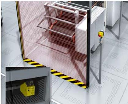
Das kontinuierliche Aufwickeln der Folienbahn stellt eine Gefahr bringende Bewegung dar. Der Sicherheits-Lichtvorhang deTec4 Core überwacht zuverlässig den Zugang zur Wickeleinheit. In Verbindung mit der modularen Sicherheits-Steuerung Flexi Soft bietet SICK damit eine Komplettlösung für die Maschinsicherheit.
