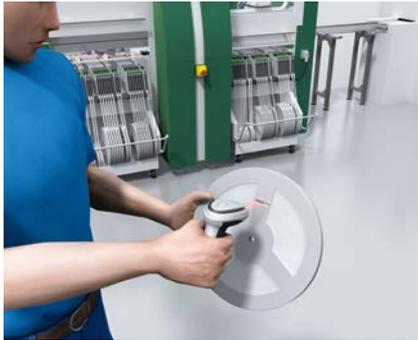
Bei der Rüstung der Feeder zeigen sich die Stärken der Handheldscanner von SICK. Rekonstruktionsalgorithmen reduzieren die manuelle Eingabe. Mit über 500 Scans pro Sekunde lassen sich Codes schnell identifizieren. Die Handheldscanner IDM sind mit Bluetooth oder WLAN erhältlich und verfügen über PS/2-, USB oder RS-232-Schnittstellen.
