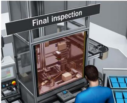
Der Sicherheits-Lichtvorhang deTec4 Core sichert den Zugriff an einer Montagestation für Endprüfung ab, da dort Werker Teile für den Prüfprozess einlegen und wieder entnehmen müssen. Dank kleiner Baugröße, variabler Halterung und Blindzonenfreiheit lässt sich der deTec4 Core ideal in die Montagestation integrieren. In Verbindung mit einem Sicherheits-Relais oder der Sicherheits-Steuerung Flexi Soft können Sicherheits-
