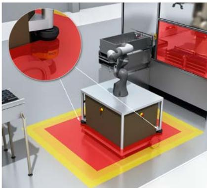
Die flexible Materialzuführung zum Rundtaktautomaten erfolgt mit einem mobilen Roboter. Der Sicherheits-Laserscanner S300 Mini lässt sich dank kompakter Bauform hervorragend in kleine mobile Einheiten integrieren. Der S300 Mini detektiert berührungslos Personen und Objekte, die sich im Fahrweg des Roboters befinden. Mechanische Schäden, wie sie z. B. bei Schaltleisten oder Bumpen vorkamen, lassen sich so ausschließen.
