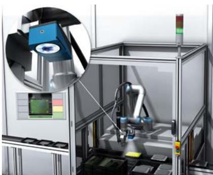
Die Software Inspector URCap ermöglicht eine einfache Integration des 2D-Vision-Sensors Inspector PIM60 in eine Steuerung von Universal Robots. Das Livebild vom Sensor, Kalibrierung und Ausrichtung nach Roboterkoordinaten sowie das Setzen von Greifposition und Wechseln von Referenzobjekten ist sofort im Universal-Robots-Steuergerät verfügbar. Eine kamerabasierte Roboterführung ist somit in nur wenigen
