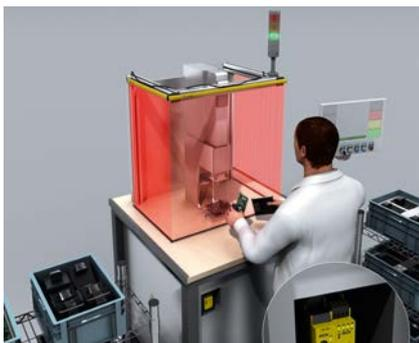
PSDI-Funktionalität bei einer optoelektronischen Schutzeinrichtung und einer Sicherheits-Steuerung umgesetzt, ermöglicht es dem Werker, den Maschinenzyklus nach dem Beladen der Maschine einfach durch Verlassen des Schutzfelds zu starten. Zwi-hand-schaltung und Fußschalter sind damit überflüssig. Da der Werker weniger Bewegungen ausführen muss, verkürzt sich die Zykluszeit pro Werkstück und
