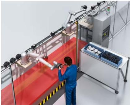
Bei der Montage von Elektromotoren entnimmt ein Roboter die auf dem Förderband zugeführten Elektromotoren und übergibt sie dem Werker zur weiteren Bearbeitung. Dieser platziert an der dafür vorgesehene Stelle im Elektromotor einen Kabelbaum. Anschließend setzt der Roboter das Werkstück zurück auf das Förderband. Der Roboter fungiert so als flexibler Produktionsassistent, der den Werker
