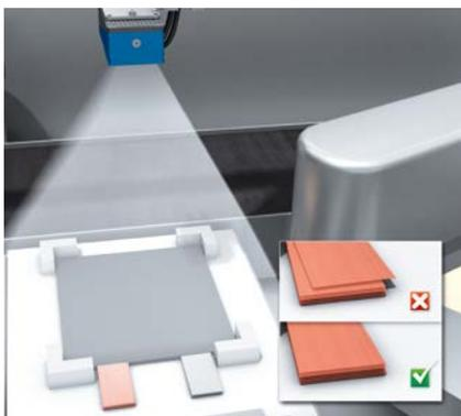
Der 2D-Vision-Sensor Inspector erkennt bereits während des Stapelprozesses die korrekte Positionierung oder Verdrehung der Elektrodenblätter. Die einfache Parametrierung mithilfe von SOPAS, einschließlich des Emulators für die Offline-Parametrierung und -Prüfung, minimiert Stillstandszeiten.
