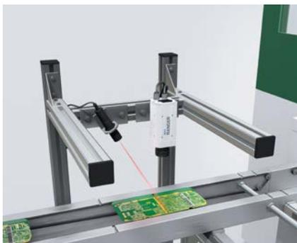
Die aufgetragene und spezifizierte Menge Lötpaste auf der Leiterplatte wird mit hohem Durchsatz und hoher Auflösung überprüft. Die 3D-Kamera Ranger bietet eine Z-Achsen-Auflösung von 5 µm bei einer Geschwindigkeit von 90 cm<sup>2</sup>/s. 3D-Inspektionslösungen von SICK unterstützen hohe Produktionsgeschwindigkeiten.
