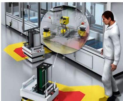
Durch Umschalten von Schutzfeldern meistern fahrerlose Transport-Carts hohe Geschwindigkeiten selbst bei Kurvenfahrten. Sichere Geschwindigkeits- und Fahrtrichtungserfassung durch Sicherheitslösungen von SICK reduziert zudem die Anzahl der Komponenten und somit den nötigen Bauraum in fahrerlosen Transport-Carts.
