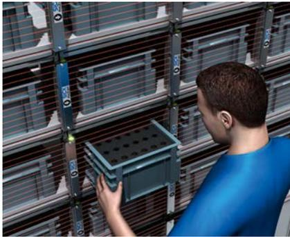
SICK ist seit vielen Jahren führend in der Entwicklung von Systemen zur Werkerführung. Das Automatisierungs-Lichtgitter PLG führt den Werker durch die 360°-sichtbare grüne Job-LED zum richtigen Entnahmefach. Greift der Werker in ein falsches Fach, löst das PLG ein akustisches Signal aus. Alternativ können auch das schmale Automatisierungs-Lichtgitter SPL sowie die 2D-Laserscanner TiM5xx oder LMS1xx zur
