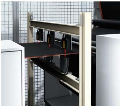
Die gleichmäßige Beschichtung der Elektrode bestimmt die künftige Qualität der Zelle. Beim Überprüfen der Beschichtungsdicke müssen Messgenauigkeiten von wenigen Mikrometern erreicht werden. Der Displacement-Messsensor OD Precision berechnet mit einer externen Auswerteeinheit schon direkt nach dem Auftrag die Dicke der Beschichtung. Das ermöglicht eine Anpassung bereits vor dem Trocknungsprozess und damit die Minimierung von Ausschuss.
