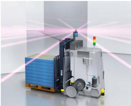
Für präzise und hochdynamische Navigation im Lager ist der NAV350 die erste Wahl. Der Sensor kann natürliche und künstliche (Reflexionsfolie) Landmarken erfassen und daraus die absolute Position des FTS errechnen. Er arbeitet nach dem Lichtlaufverfahren: Zur Positionsermittlung reichen bereits drei Reflektoren aus.
