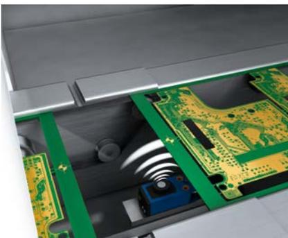
Objekte im Hintergrund oder Bewegungen spiegelnder Maschinenteile erschweren häufig eine präzise und zuverlässige Kantendetektion der Leiterplatte. Der hochauflösende, kompakte Ultraschallsensor UC4 erfasst nur die Leiterplatte, auch wenn z. B. der Bestückkopf nur Millimeter von der Leiterplatte entfernt ist.
