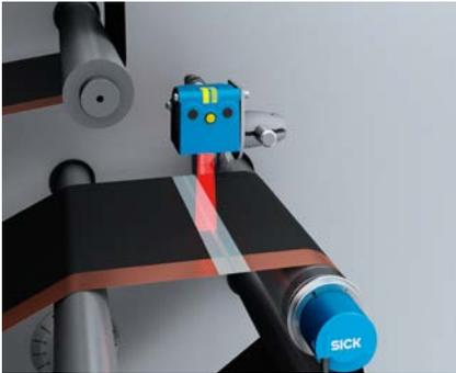
Beim Rollenwechsel werden Folienende und -anfang von zwei aufeinander folgenden Rollen mit einem Spliceband verbunden. Farb-, Kontrast-, Lumineszenz- und Glanzsensoren von SICK detektieren das Band, damit es vor der Weiterverarbeitung der Folie zur Zelle entfernt werden kann. Ein SICK-Encoder erhöht zusätzlich die Genauigkeit der Positionsbestimmung.
