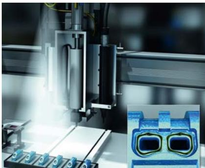
Nach dem Fügeprozess lässt sich die Qualität des Objekts nicht mehr ohne Schäden prüfen. Optische Überwachungssysteme vergleichen Lage, Unterbrechungen und Qualität des beim Fügeprozess verwendeten Klebstoffs mit einem Muster und dokumentieren Fehler. Der 2D-Vision-Sensor Inspector PIM60 Bead ermöglicht unmittelbar nach dem Auftragen des Klebstoffs eine lückenlose Konturprüfung der Klebe-
