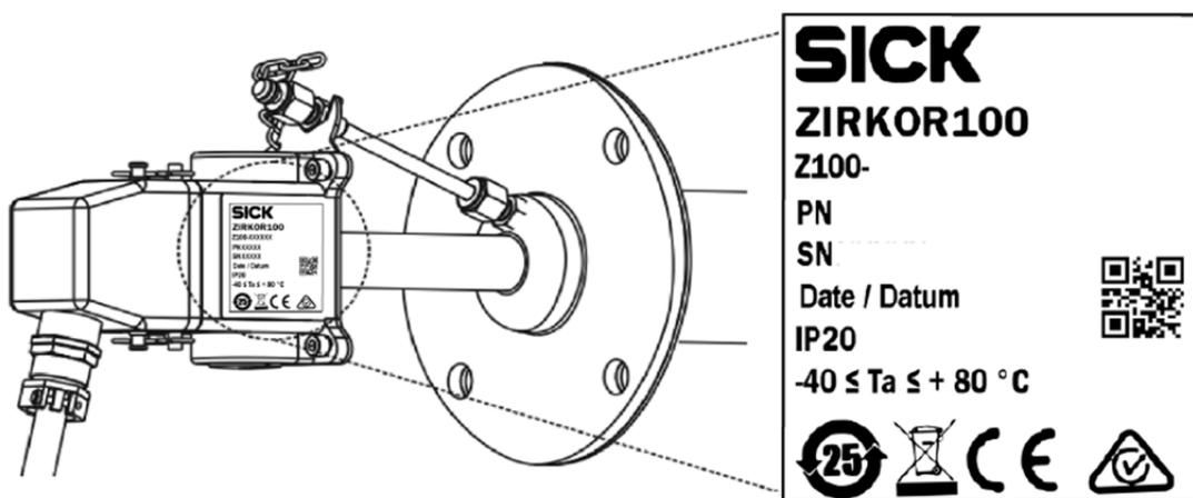
Figure 4 - Name Plate O<sub>2</sub> Probe
