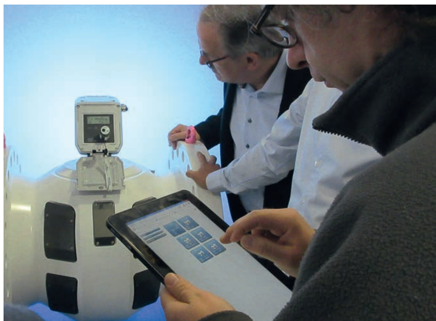
FLOWgate™ ermöglicht über PC oder Tablet-PC jederzeit den Online- oder Offline-Zugang zum Gaszähler und damit zu allen Messwert- und Diagnosedaten.
