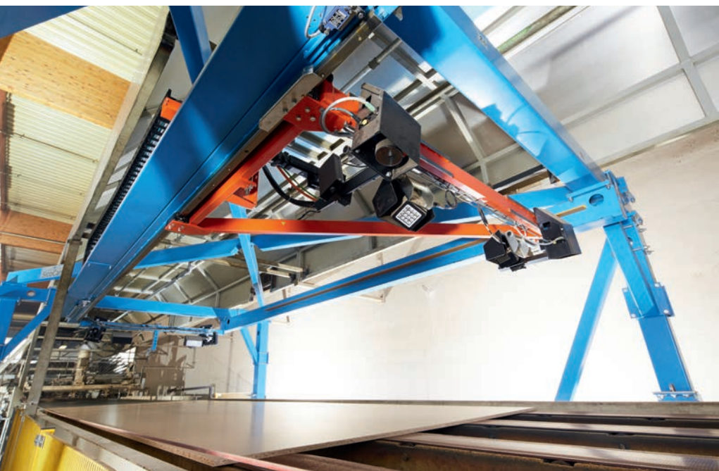
SicoCam-Portal mit vier programmierbaren 2D-Kameras Inspector65x.
