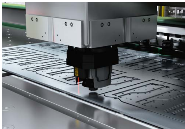
圖11：使用OD Max位移感測器在切割頭上的距離檢查
