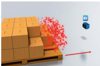
Deuxième étape : Mesurer le temps de propagation de la lumière pour retourner à la caméra.
