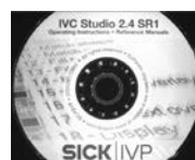
Avec éclairage annulaire, plus de contraste, observer l'éblouissement sur le centre brillant du disque.
