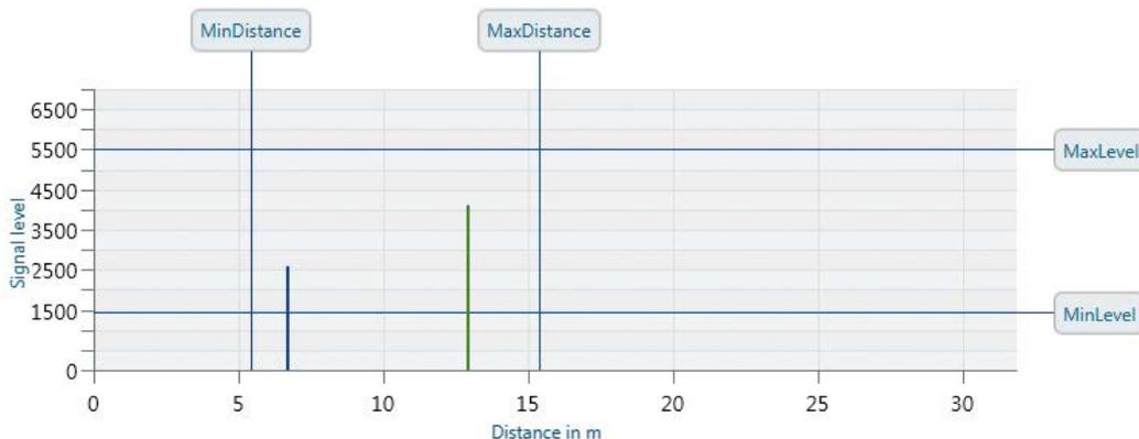
Fig. 4: indicazione grafica e impostazione della Region of Interest del sensore di distanza SICK Dx1000.
