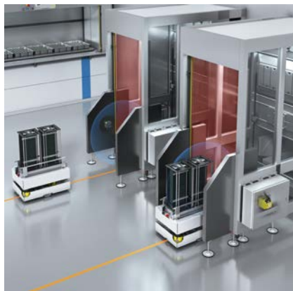
Protection de zone dangereuse lors de l'amarrage de véhicules sans conducteur avec le système de sécurité Safe Entry Exit
