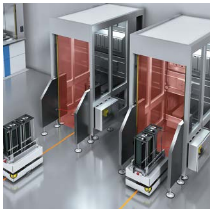
Protection de zone dangereuse lors de l'amarrage de véhicules sans conducteur avec des barrages immatériels de sécurité
