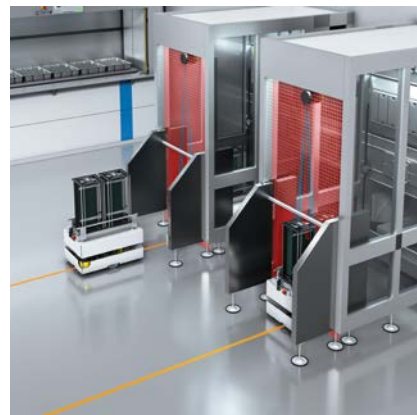
Protection des zones dangereuses lors de l'amarrage des véhicules sans conducteur avec le système de sécurité Safe Portal
