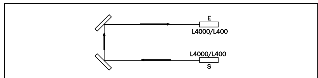
Afb. 14: Voorbeeld van een tweestraals toegangsbeveiliging met een systeem L4000/L400 en hoekspiegels
