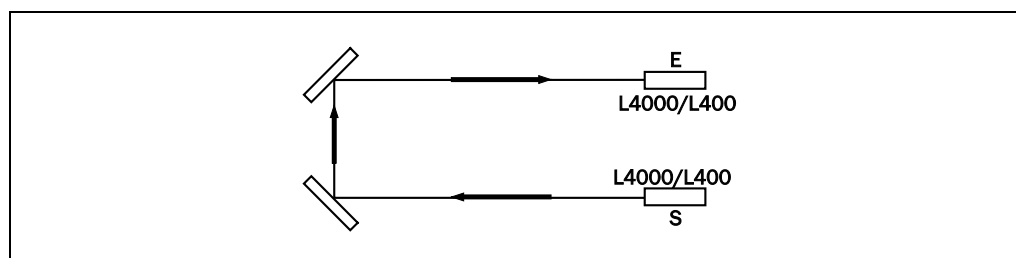
Fig. 14: Exemplo de uma protecção, contra o acesso de pessoas, de dois feixes com um sistema L4000/L400 e espelhos deflectores
