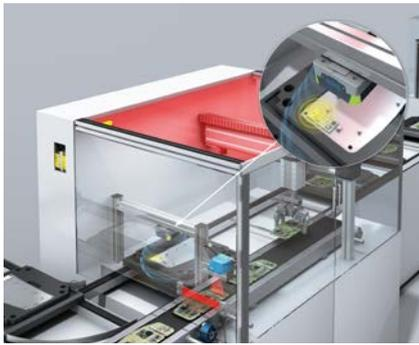
RFIDを使用することで、製造プロセスを高い信頼性で制御および監視することができます。各アセンブリステーションでICタグのデータを基に個々の製造指示が実行されます。アセンブリがワークピースキャリアから離れていたり、プラスチック筐体内に装着されていても、アセンブリに取り付けられたUHFタグにより関連データが提供されます。従って、ロジスティクスや複数アセンブリの最終アセンブリ工程などの下流プロ
