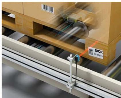
パレット搬送技術の領域で安定したエラーのないマテリアルフローを確保するには、パレットおよびその積荷の存在検出、突出部点検、高さ測定のための信頼性が高く堅牢なセンサが必要です。バーコード読み取りやRFID技術といった自動パレット識別ソリューションは、ルーティング情報および保管場所割り当てをサポートします。
