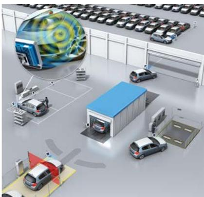
生産プロセスでは、車両を明確に識別して追跡する必要があります。ボディ製造からペイント、最終アセンブリまでは車両は製造ライン上でガイドされており、比較的簡単にこのタスクを行うことができます。しかし、再加工および検査ステーション、ならびに工場敷地内の駐車場など、次のステーションまでの経路においても車両を追跡する必要があります。この際、読み取り機器までの様々な距離、様々な読み取り速度、およびトリガが存在しないことなどへの対応が課題となります。そこに、RFU65xまたは追加アンテナ
