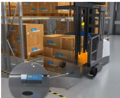
ドライバーアシスタンスシステムは、通路の狭い倉庫であっても、フォークリフトドライバーが迅速かつエラーなしで次の保管スペースに移動できるようにサポートします。頑丈でスペースを取らないRFID ICタグがフロアに埋め込まれており、フォークリフトに取り付けたRFIDリーダ/ライタRFH620がICタグを読み取ります。車両制御によりラックの目標スペースで自動的に停止します。
