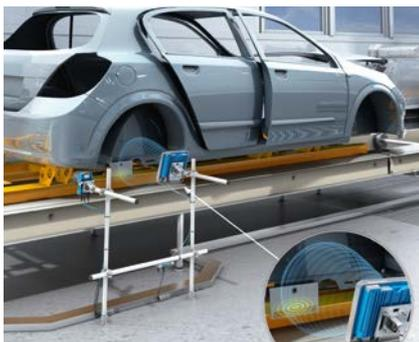
UHF技術を搭載したRFIDリーダ/ライタにより、ボディ製造からペイント、さらに最終アセンブリに至るまで、自動車生産の全製造工程で車両を確実に識別できるようになります。ホイールアーチに引っ掛けられたUHFタグにより車両が識別されます。UHFタグは遠い距離からでも常に読み取り可能です。MES (Manufacturing Execution System = 製造実行システム) は、ICタグの車両識別番号に基づき、各製造ステップで任意
