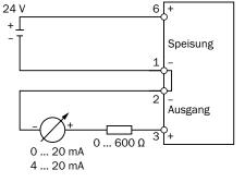
3 Leitertechnik Stromausgang 4 Leitertechnik Stromausgang
