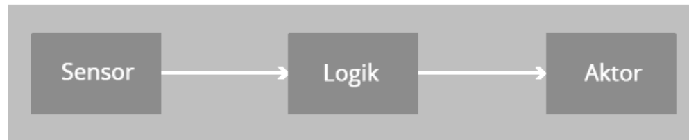
Abbildung 1: Allgemeine Darstellung einer sicherheitsgerichteten Funktionskette
