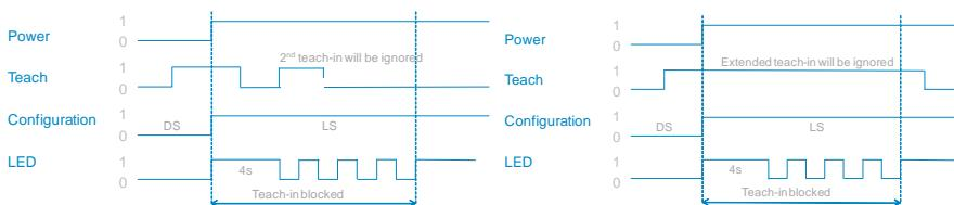
Abbildung beschreibt die Umschaltung von dunkel auf hell (im umgekehrten Fall verhält sich die LED genau invers).
