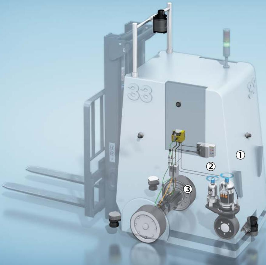
**① Geschwindigkeitserfassung an einem fahrerlosen Transportfahrzeug (FTF)**
