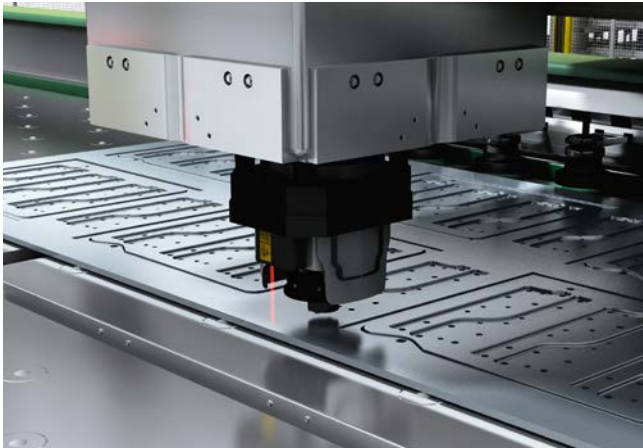
Figura 11. Control de distancia en el cabezal de corte con el sensor de desplazamiento OD Max
