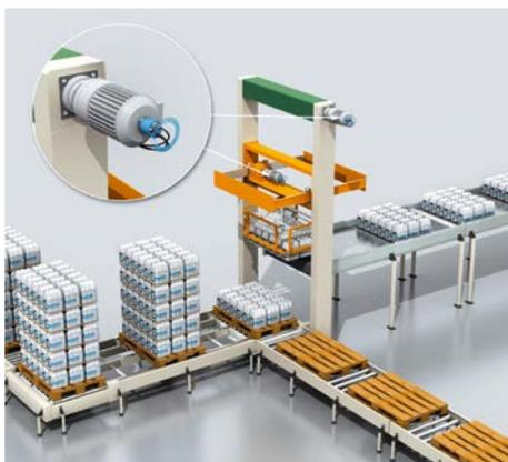
Instalación de paletizado: posicionamiento de la pinza
