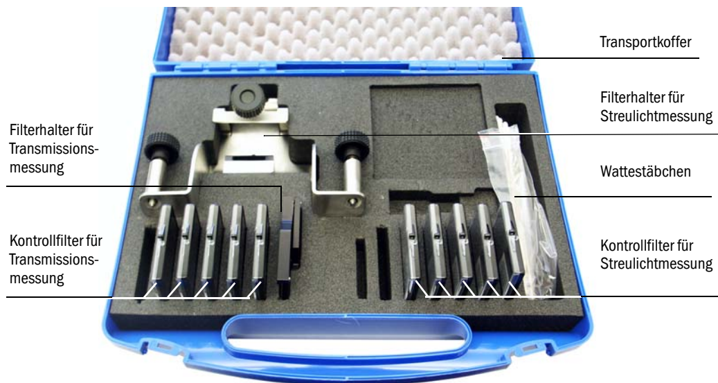
Bild 10 Komponenten des Linearitätsprüfmittels
