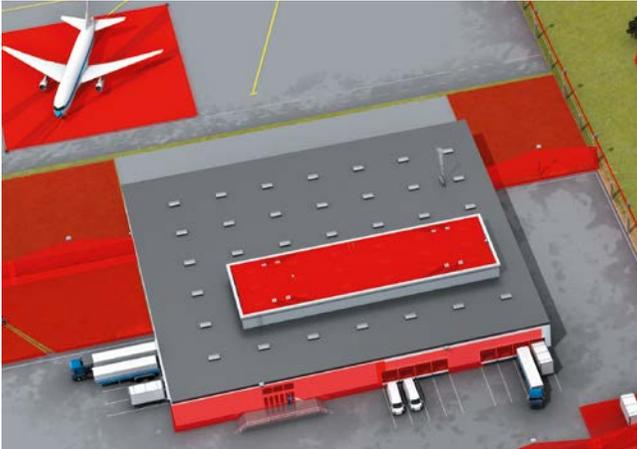
Perimeterschutz per Sensor beginnt an der Einfriedung eines Geländes, z. B. einem Zaun oder einer Mauer, und endet an der Gebäudehülle. Um diese Bereiche abzusichern, wertet eine sensorinterne Software alle Überwachungsfelder aus. Dringt jemand oder etwas in ein Überwachungsfeld ein, wird ein Alarm ausgelöst. Um z. B. die Position einer Person auf dem Gelände zu bestimmen, werden die Messdaten der Sensoren verwendet.
