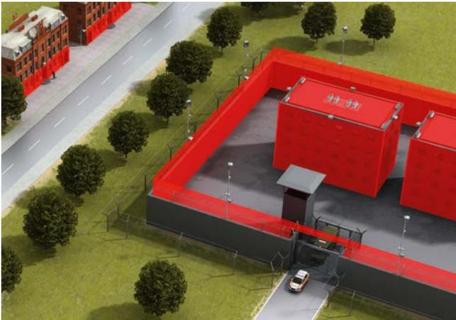
Der Objektschutz in Außenbereichen umfasst das Absichern von Dächern, Fassaden, Türen, Toren, Fenstern und Oberlichtern. 2D-Laserscanner registrieren jede noch so geringe Bewegung innerhalb der Schutzfelder. Ihre hohe Reichweite und die Tag- und Nachtschaltung ermöglichen ein flexibles Sicherheitskonzept. Falschalarme durch Tiere oder Blätter werden durch die Wahl der zu detektierenden Objektgröße reduziert.
