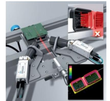
Il sistema di controllo qualità Pinspector verifica in modo affidabile se tutti i pin di un connettore a spina sono presenti e intatti.
