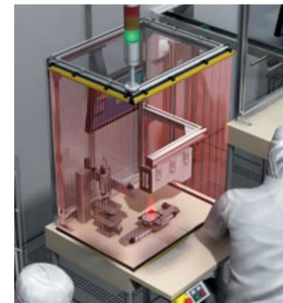
Protezione intelligente della zona d'accesso con la barriera fotoelettrica miniTwin4 per la massima produttività
