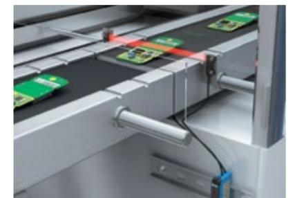
velocità. Gli amplificatori per fibre ottiche WLL180T soddisfano questa esigenza elaborando il segnale ad alta risoluzione e assicurando tempi di risposta estremamente brevi per cicli velocissimi. Un conduttore a fibre ottiche LL3-DT01 compensa le leggere vibrazioni del filo di saldatura con il suo ampio angolo di rilevamento.
