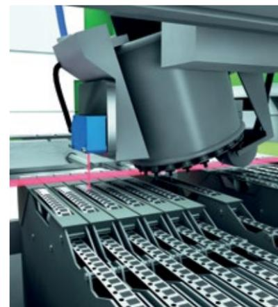
OD Mini: misurazione della distanza per l'automazione dei prodotti supportata da robot.
