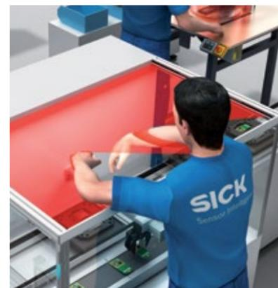
Protezione di un robot manipolatore tramite sensore ottico di sicurezza V300 Work Station Extended.
