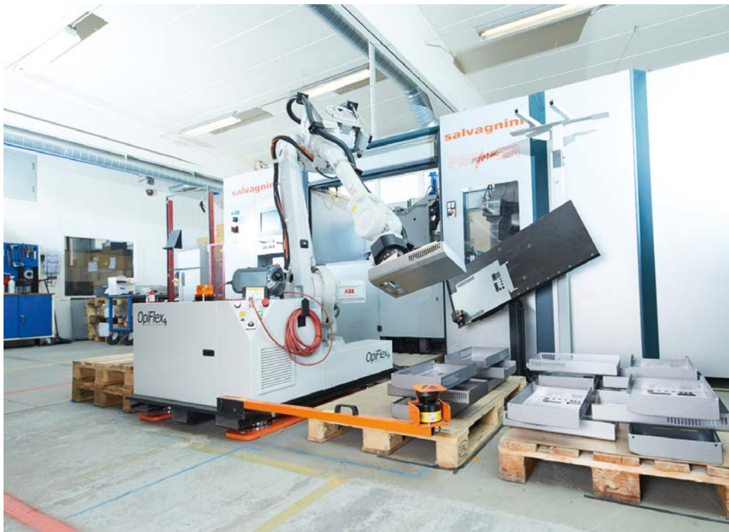
防護柵なしで移動型使用可能な大型産業用ロボット
