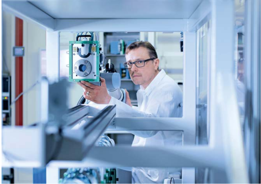
相互作用形態「コラボレーション」では、人間とロボットが同じ時間に同じ作業空間で作業します
