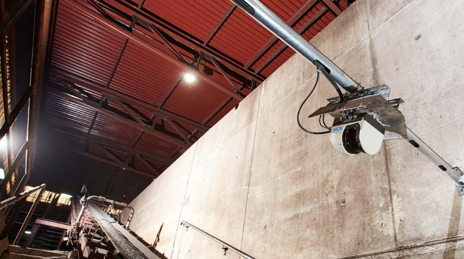
LASER-VOLUMENSTROMSENSOR SORGT FÜR DIE RICHTIGE DOSIS UND MENGE EISENSPÄNE
