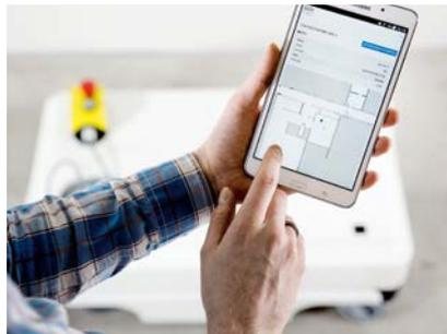
Der MiR100 kann mit einem Tabletcomputer, einem Mobiltelefon oder PC gesteuert werden.
