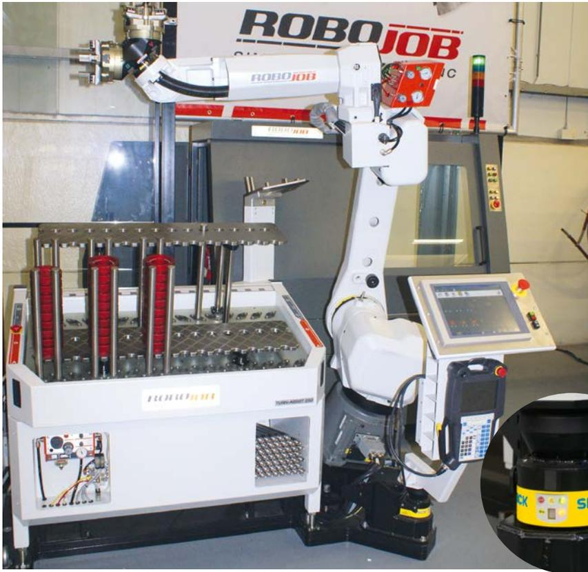
Automatische Beladung einer Werkzeugmaschine mit einer Roboterlösung von RoboJob.
