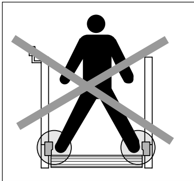
Fig. 14: Los sensores enfrentados no deben ser activables simultáneamente
