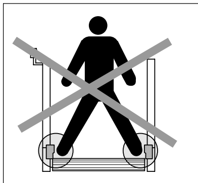
Abb. 14: Gegenüberliegende Sensoren dürfen nicht gleichzeitig aktivierbar sein
