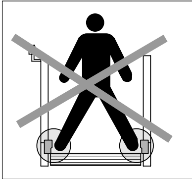
Fig. 14: Os sensores opostos não devem ser activáveis ao mesmo tempo
