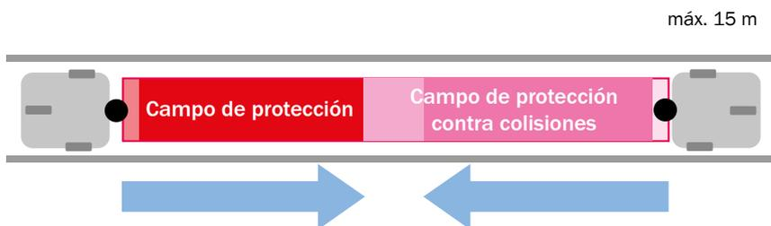
Mayor rendimiento y flexibilidad con la máxima seguridad: gracias al campo de protección contra colisiones (KSF) adicional, los vehículos se detectan con seguridad hasta una distancia de 15 m.
