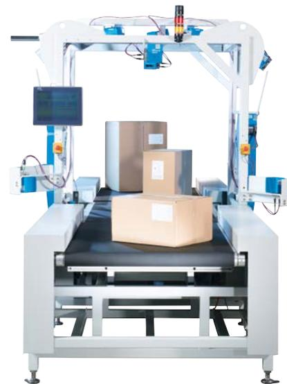
Sistema combinado de dimensionamiento, pesaje e identificación (DWS)
