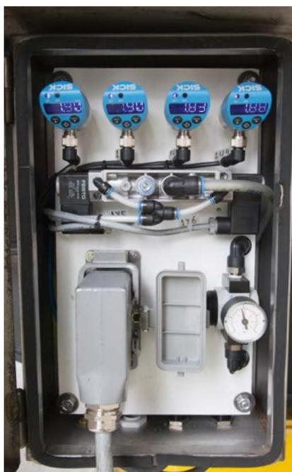
Cuatro sensores de presión PBS monitorizan la presión y la depresión
