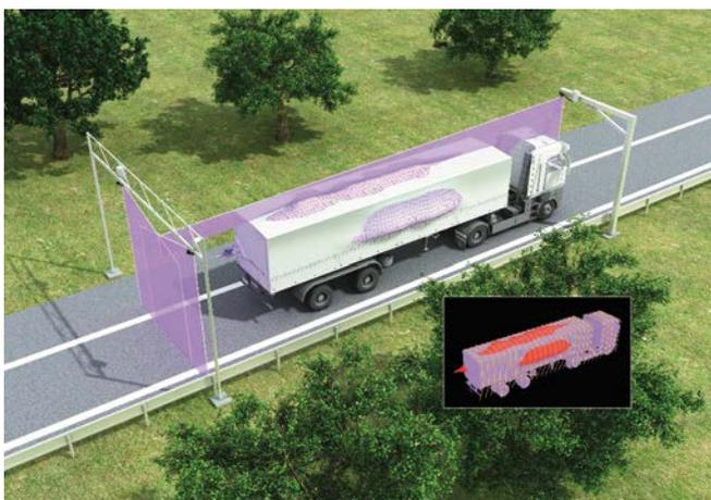
Abb. 15: Vermessung des Lkw-Profiles mit drei 2D-LiDAR-Sensoren
