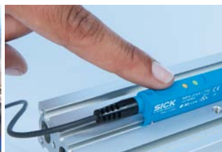
Ajuste intuitivo del sensor mediante tecla teach-in.
