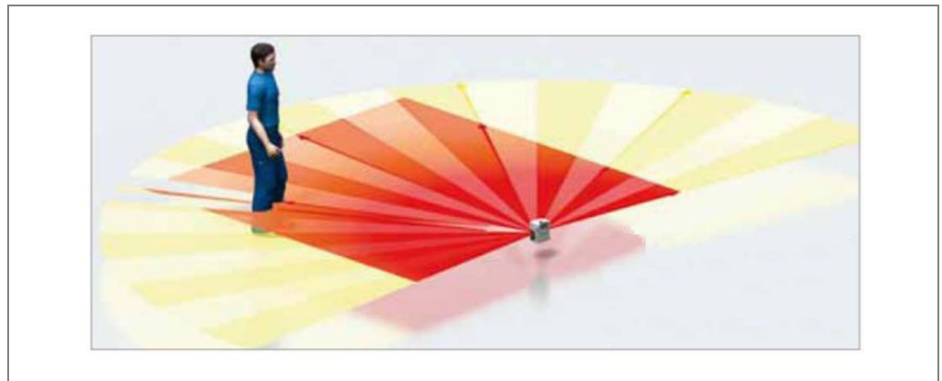
Ill. 1 : Principe de fonctionnement du scanner laser 2D
