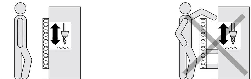
図 7: 上から手を伸ばした場合の ESPE の接近可能性。左: 上から手を伸ばしても防護フィールドに到達できない。右: 上から手を伸ばすと防護フィールドに到達できる。
