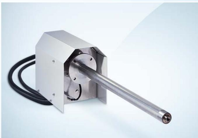
L'unité de prélèvement de gaz permet de prélever le gaz à mesurer au point de mesure en toute fiabilité et de le transporter jusqu'au système d'analyse. Du prélèvement d'échantillon à la cellule de mesure, tous les composants en contact avec le gaz à mesurer sont chauffés et maintenus au-delà du point de rosée et ainsi protégés contre la corrosion – Le MCS200HW représente la technique de mesure à chaud novatrice de SICK.
