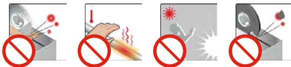
Bild 2: Gefährdungen, bei denen berührungslos wirkende Schutzeinrichtungen nicht eingesetzt werden können.
