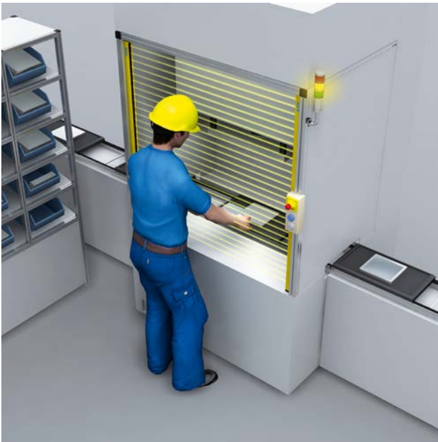
Bild 26: 1-Takt-Betrieb mit Sicherheits-Lichtvorhang an einem Montageautomaten. Beim Einlegen befindet sich das Werkzeug im oberen Punkt. Nach Freigabe des Schutzfelds durch den Bediener wird der Montageprozess automatisch eingeleitet.
