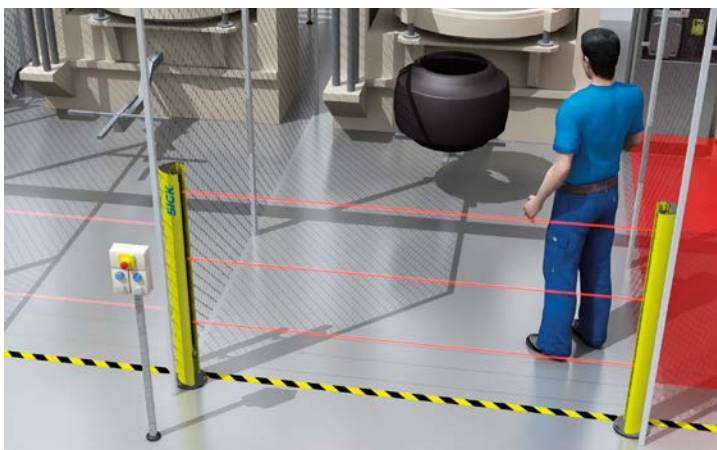
Bild 5: Zugangsabsicherung mit einer Mehrstrahl-Sicherheits-Lichtschränke.
