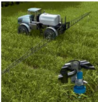
UM30-ultralydssensorer - korrekt arbejds højde for marksprøjter.
