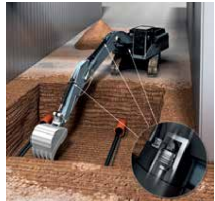
Dybdekontrol: Beskadigelse af ledninger undgås.
