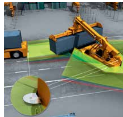
Læsestationer på havnen: MRS1000 hjælper kranføreren ved pålideligt at registrere omgivelserne på jorden; føreren af containertrucken hjælper den med lastningen af containere.
