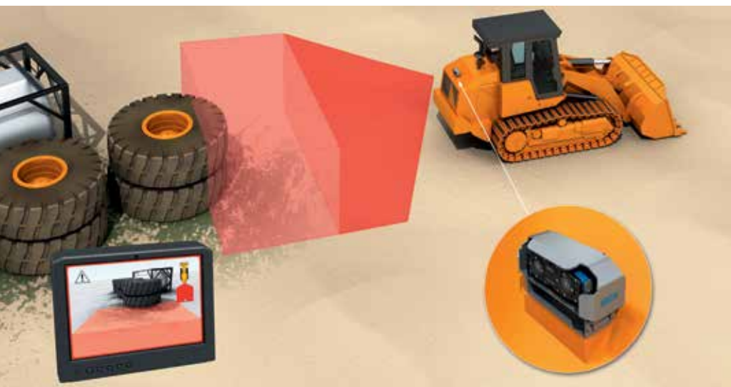
3D-vision-sensoren Visionary-B registrerer pålideligt personer og objekter i den døde vinkel og advarer mod dem.
