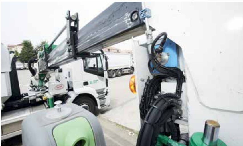
Den smalle wireencoder EcoLine registrerer pålideligt, hvor langt griberen er kørt ud.
