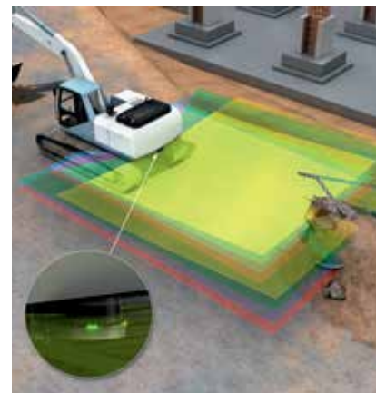
Gennem den samtidige måling på fire niveauer registrerer MRS1000 også objekter, der ligger på jorden, eller objekter, der rager ud. Allerede i mellemstore gravemaskiner er førerens udsyn stærkt begrænset.
