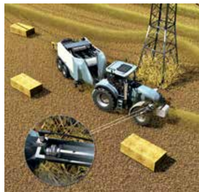
Fulldautomatisk sporføring - et vigtigt skridt hen mod den autonome traktor.
