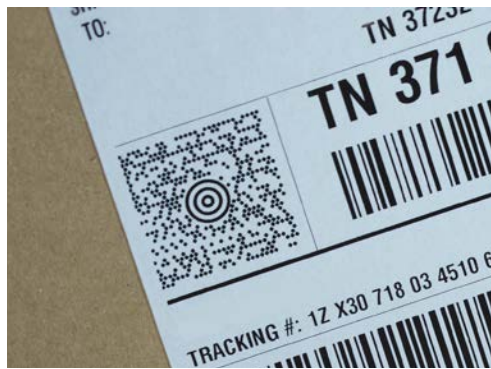
Figure 6 : Les services de messagerie misent souvent sur une combinaison de codes 1D et 2D (ici un MaxiCode).
