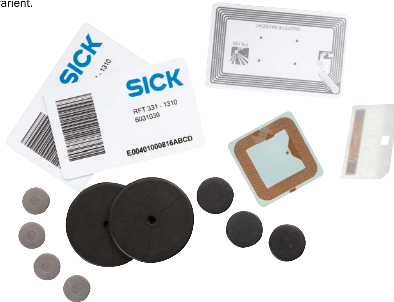
Figure 2 : Les transpondeurs passifs HF et UHF RFID de formes diverses facilitent la fixation sur les objets et l'utilisation comme carte d'identification. Les designs d'antennes et des puces d'étiquettes UHF et HF se distinguent nettement par le fonctionnement différent du transfert d'énergie et de données (étiquette tout à fait à droite : UHF, les autres : HF).
