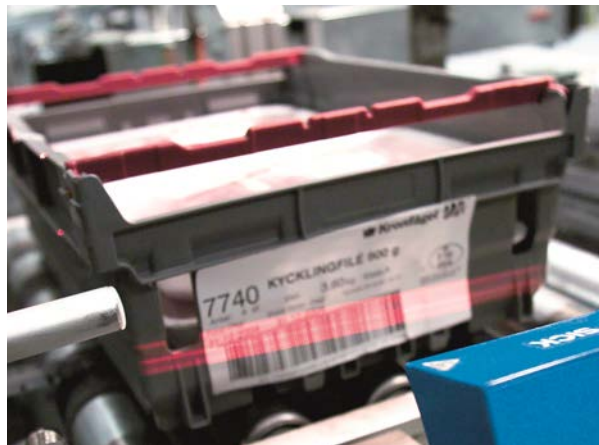
Figure 4 : Les lecteurs à miroir oscillant lisent des code-barres au sein d'une zone définie, même dans des conditions d'éclairage difficiles.
