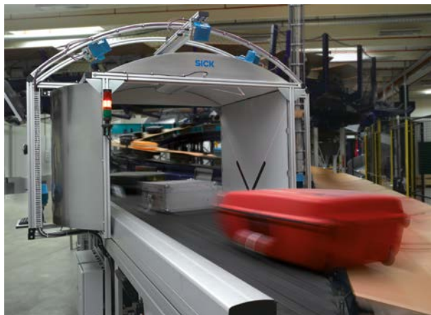
Figure 1 : Les combinaisons des technologies RFID et lecteurs laser sont par exemple utilisés dans les aéroports dans les systèmes d'identification des bagages pour le tri des bagages (gauche) et dans les Self-Bag Drops (droite).
