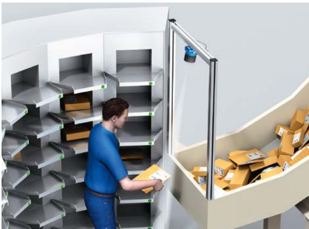
Figure 8 : Les caméras matricielles lisent des codes 1D et 2D imprimés ou marqués directement, par exemple pendant le processus de tri des colis (à gauche) ou pour l'identification univoque de composants tels que des blocs moteur dans la fabrication (à droite).
