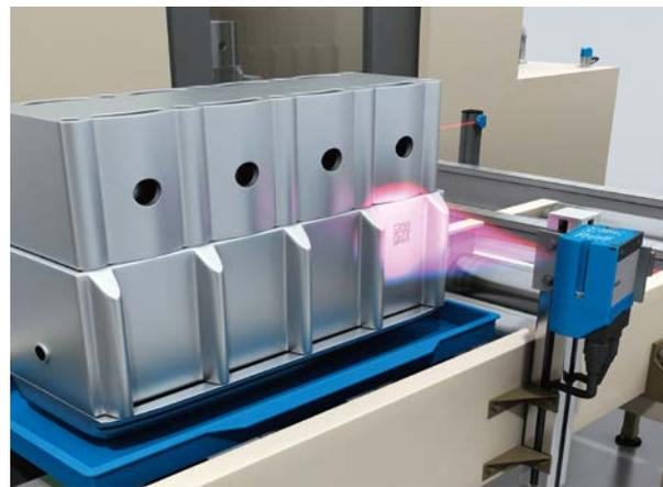
Immagine 8: Le telecamere matriciali leggono i codici 1D e 2D stampati o direttamente marcati, ad esempio durante il processo di smistamento di pacchetti (a sinistra) o per l'identificazione di componenti come blocchi motore in produzione (a destra).
