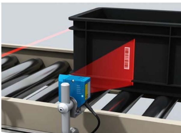
Immagine 5: I laser scanner sono molto diffusi nei magazzini perché sono in grado di identificare con sicurezza i contenitori per il caricamento se montati lateralmente nei nastri trasportatori. Il disegno mostra uno scanner lineare che viene attivato da un sensore fotoelettrico a riflettore.
