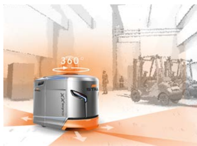
De cubeXX bepaalt zijn positie zelf op grond van vooraf bepaalde oriëntatiepunten en analyseert de directe omgeving in 3D
