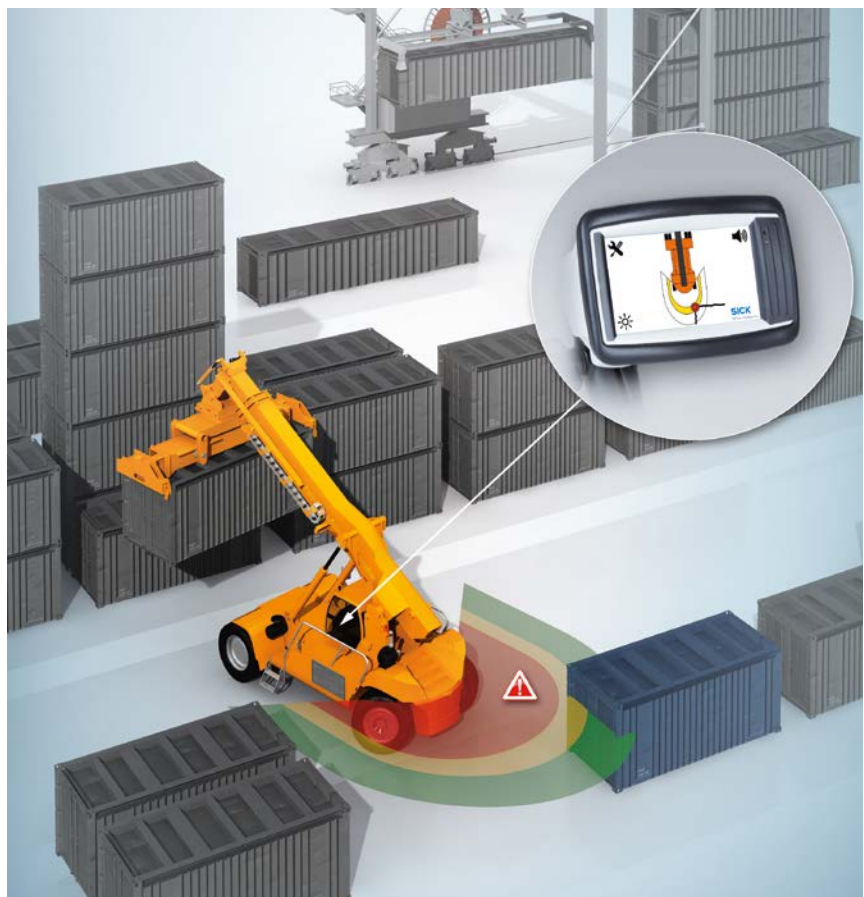
RAS Prime voor hulp bij het rijden: overtuigt met drie waarschuwingszones en bedieningsdisplay, waarop botsingsrelevante objecten worden weergegeven
