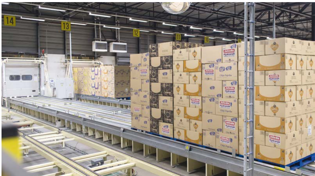
Dockingsysteem: 10 pallets zijn ingedeeld in één groep
