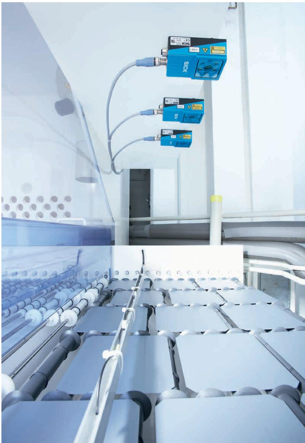
Qualitätsprüfung bei der Produktion der Solarmodule mit Inspector PIM-series
