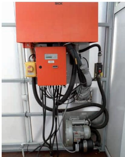
Spezielle Lösung für die Düngemittelproduktion: FWE200 mit integrierter Spülung
