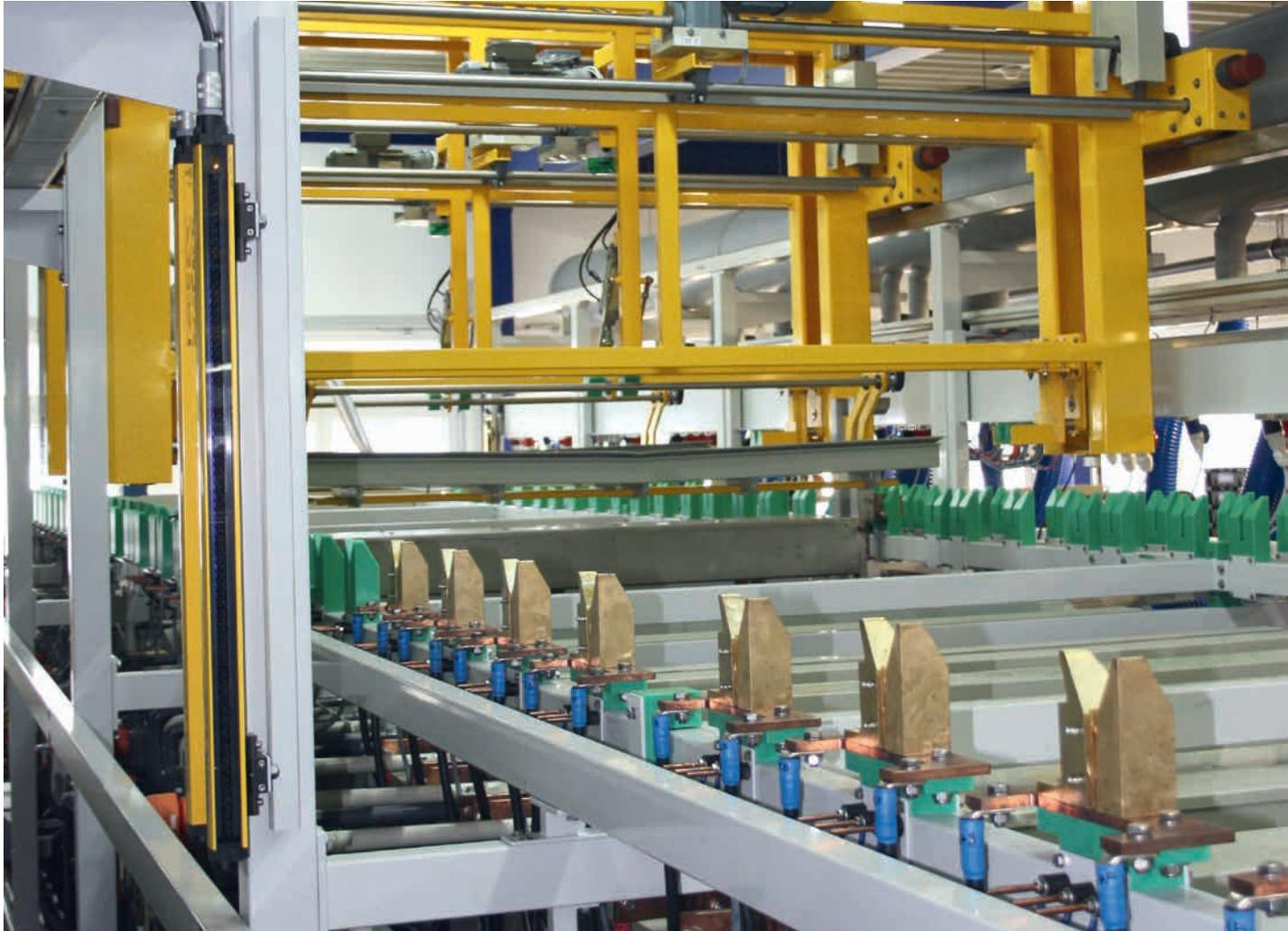
52 Tauchbecken mit 80 Anfahrpositionen in einer Linie von 27 Metern Länge, beschickt durch drei automatische Laufwagen: Das sind die wichtigsten Details der neuen, ultramodernen Galvanikanlage der GALVABAU AG, die beim Leiterplattenspezialisten Varioprint AG in Heiden in der Schweiz seit 2013 in Betrieb ist. In die vollautomatische Anlage sind Sensoren von SICK integriert – Ultraschallsensoren UP56 zur Füllstandmessung und Sicherheits-Lichtvorhänge C4000 zur Bereichsabsicherung.
