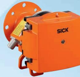
In-situ-IR-Gasanalysator GM35 – misst  $\text{CO}_2$  und CO oder  $\text{N}_2\text{O}$  simultan. Sende-Empfangs-Einheit und Reflektor liegen am Gas-kanal gegenüber. So durchläuft der Lichtstrahl zur Erhöhung der Genauigkeit den gesamten Kanaldurchmesser zweimal; mit integriertem Selbsttest und Kontrollfunktionen.
