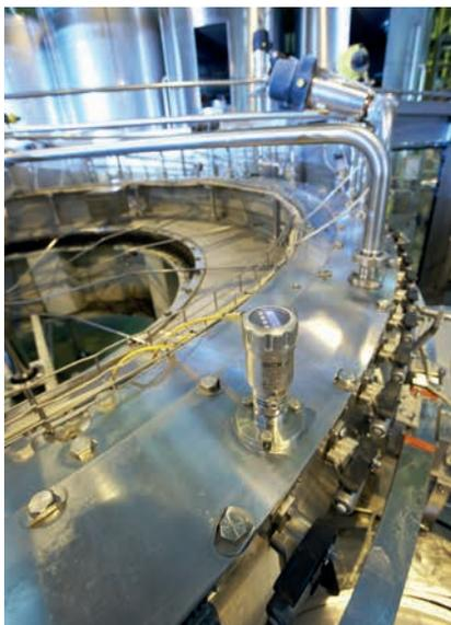
Zuverlässig auch bei stark schäumenden Medien: LFP Inox im Einsatz an einem Rundabfüller
